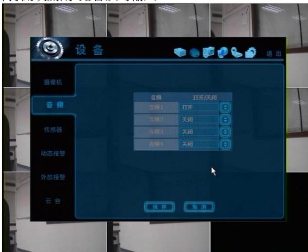
**注意** 音訊是用於記錄和通過網路轉輸的，也就是說使用者不能在DVR的即時顯示模式中聽到任何聲音但能在重播模式中聽到，然而使用者可以借由網路通過遠端監控的即時傳輸和遠端重播或IE瀏覽器在實況裡聽到聲音。
