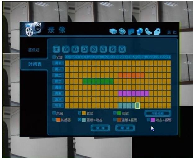
**注意** 如果在錄影時間表裡設置了“連續 + 動態偵測”或“動態偵測 + 啟動感測器”，然後DVR將以持續或動態偵測模式錄影，相反，如果在“設備”功能表的“感測器”或“動態偵測”被設定時候當動態區域裡有運動發生或啟動報警時，錄影模式將自動切換到緊急錄影模式。
