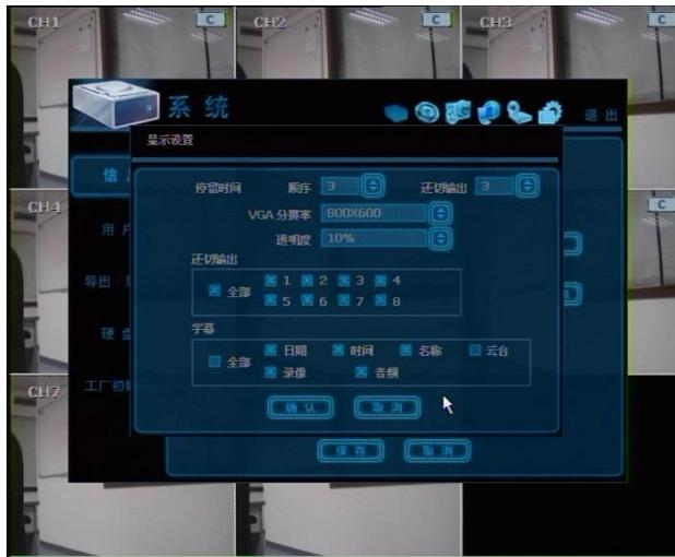
**注意** 這個系統支援多種顯示解析度：640x480、800x600、1024x768和1280x1024
